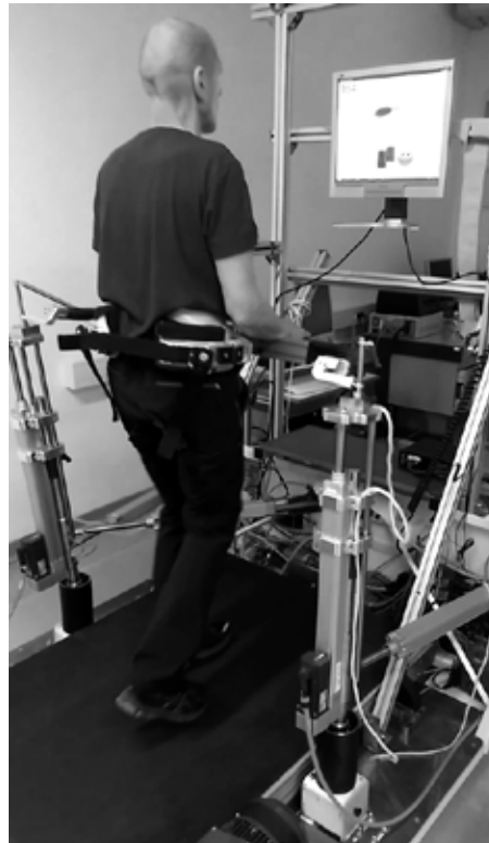
OSEBA PO PREBOLELI MOŽGANSKI KAPI HODI PO TEKOČEM TRAKU OB PODPORI ROBOTA BAR-TM.
